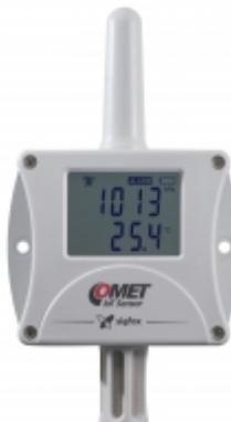
Přístroj měří teplotu, vlhkost atmosféricky tlak z vestavěných čidel. Vyznačuje se jednoduchým kompaktním provedením a umísťuje se přímo do měřeného prostoru. Naměřené hodnoty jsou zobrazovány na displeji a pravidelně odesílány, v nastavitelném časovém intervalu (10 min až 24 h), rádiovým přenosem v síti Sigfox do Comet Cloud.
